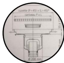
**Réservation de faibles dimensions :** l'installation des caniveaux à sortie verticale de nécessité pas de décaissé dans la dalle. Un carottage de Ø 225mm est suffisant.
